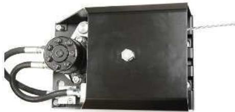
Das Ventilblech an einer geeigneten Stelle festschweißen, mit Schlauch, Ventil und Fernbedienug kontrollieren, dass es gut wird. Die Hydraulikschläuche wie auf der Abbildung montieren:
