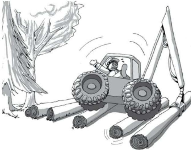
Vermeiden, über gefällte Stämme oder anderes nachgiebiges oder rutschiges Material zu fahren, um die Kippgefahr bzw. die Gefahr des Herabfallens und der Beschädigung des Ladeguts einzuschränken.
