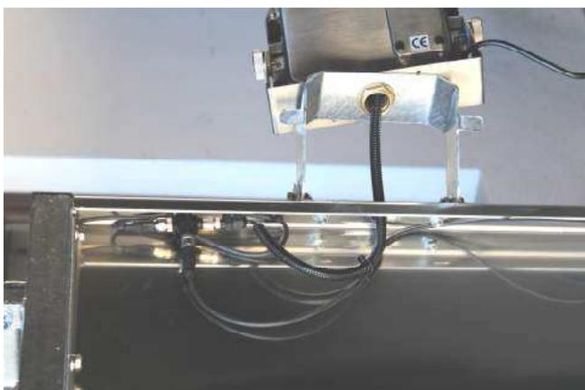
Ziehen Sie das Wiegesignalkabel der Anzeige durch die Verschraubung und durch den Befestigungsbügel nach unten und stecken Sie es an den Verteiler an. Stecken Sie die anderen beiden Wiegesignalkabel ebenfalls an den Verteiler an.
