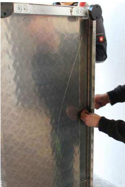
Montieren Sie die jeweils 4 Schrauben pro Seite für die Verschraubung des Bodenbleches mit den unteren Seitenteilen.
