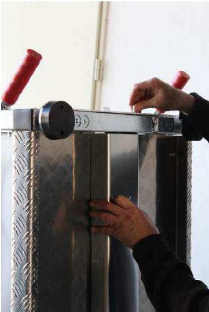
Stecken Sie auf beiden Seiten die je 2 Linsenkopfschrauben von außen nach innen.
