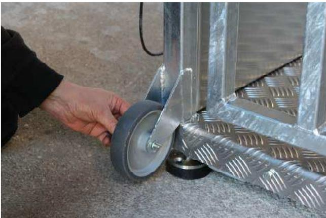
Montieren Sie die beiden Räder an der Vorderseite der Waage. Zwischen Rad und Befestigungslasche ist je eine Scheibe vorgesehen. Die Räder haben eine gelagerte Innenbuchse, die Schrauben können daher festgezogen werden.
