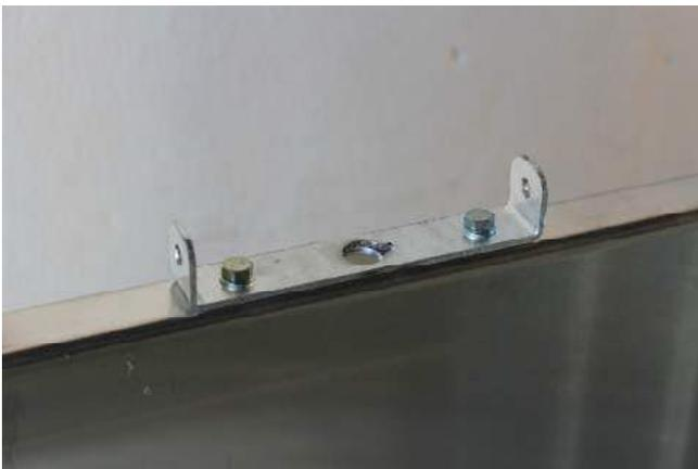
Befestigen Sie den Montagewinkel an der rechten Seite der Waage.
