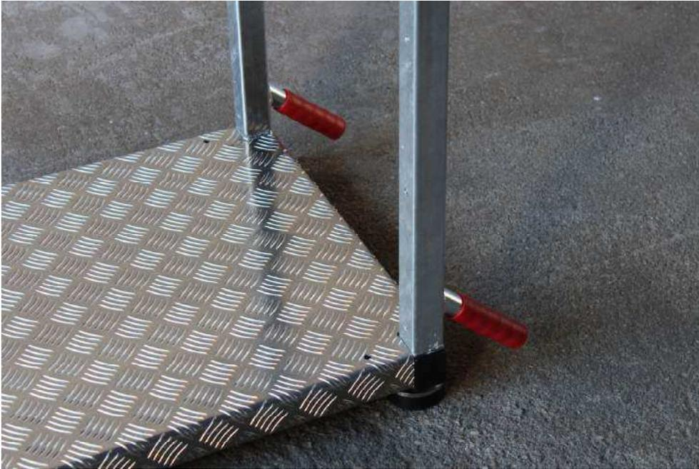
Heben Sie das Bodenblech auf der anderen Seite hoch, schieben Sie den Rahmen unter das Blech und hängen Sie auch die zweite Seite ein.
