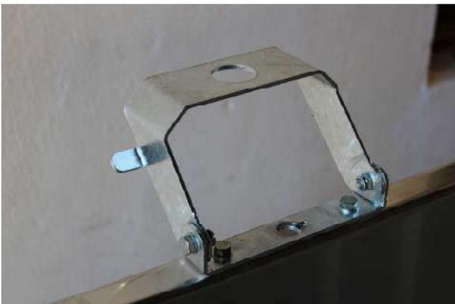
Montieren Sie den Haltebügel für die Anzeige lt. Abbildung. Der Haltebügel ragt im Normalzustand nach außen, und lässt sich nach innen klappen.
