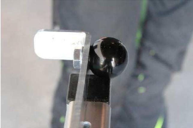
Montieren Sie die Kugel außen am Hebel.
