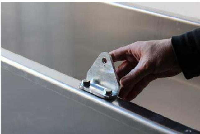
Befestigen Sie den Montagewinkel an der linken Seite der Waage mit 2 M8 Schrauben. Der stehende Teil muss nach innen zeigen.
